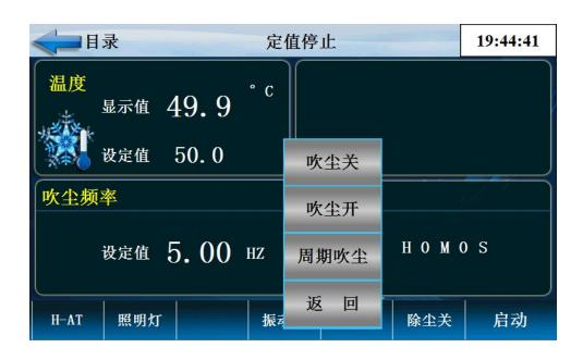
吹尘关:吹尘关闭 吹尘开:吹尘打开 周期吹尘:吹尘周期开关 返回:返回 上一画面 点面除尘进入如下画面
