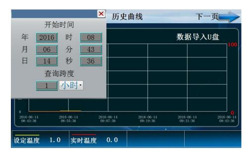
开始时间为查询曲线的开始时间查询跨度为查询曲线的跨度时间
