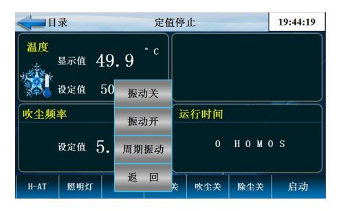
振动关:振动关闭振动开:振动打开 周期振动:振动按 周期打开关闭 返回:返回上画面 点击吹尘进入如下画面
